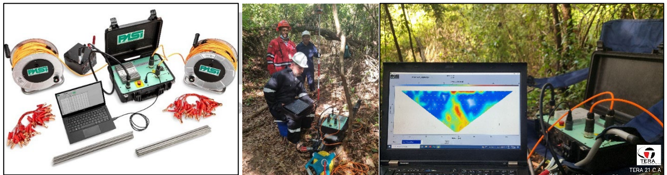
Figura 6. Instrumental utilizado en campo para mediciones de tomografías eléctricas y polarización inducida.
